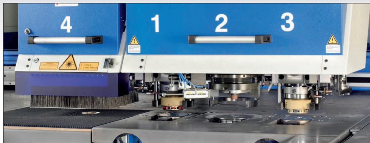
CombiLaser TRI 3 têtes de poinçonnage avec 2 REVOTOOL (Tête 1 & 3) et rotation/Index (tête 2)
