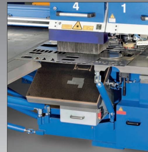
Les pièces découpées au laser peuvent être rapidement évacuées de la surface de travail dans un bac via 2 zones de trappes de taille 150x150mm et 670x670mm et disposées en face de la tête laser. Leur basculement à 30° se fait au moyen de vérins pneumatiques.
