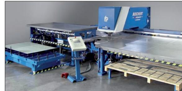
Le chargeur est situé sur le côté gauche de la machine et se met en lieu et place de la table „standard“. Le système de chargement extrêmement compact est constitué des composants suivants:
