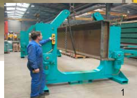
301 Abaisser une poutre Lower the beam
