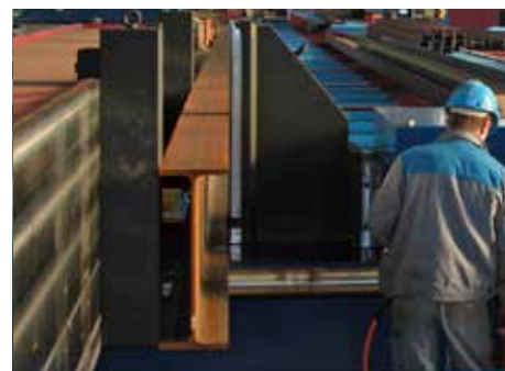
277 Presse dans la fabrication de parachèvement de poutrelles / Toegmachine geïntegreerd in balken lijn
