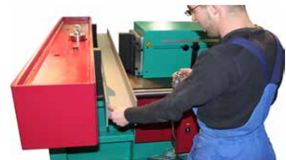
183 Redressage à l'aide de la commande à distance manuelle Richtwerkzaamheden d.m.v. een handdrukknop
