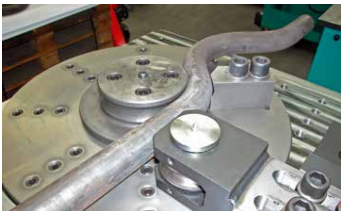
253 Construction de la table standard avec contre pièce de maintien, entraîneur et axe de pliage. / Standard tafel m. opbouw v. tegenhoudrol, meenemer e. buigbout
