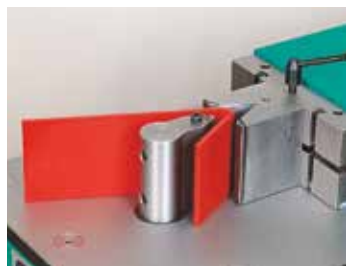
61 Pliage avec prisme en V Buigen met V-prisma
