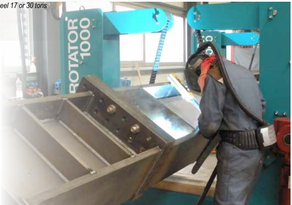
312 Soudage et nettoyage en position berceau augmentent la productivité Lassen en reinigen in ophangpositie verhoogt de productiviteit
