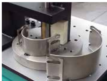
87 Pliage tôle > 90° Buigen van plaat > 90°
