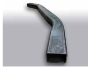
80 Pliage grands tubes rectangulaires Buigen van grote buizen
