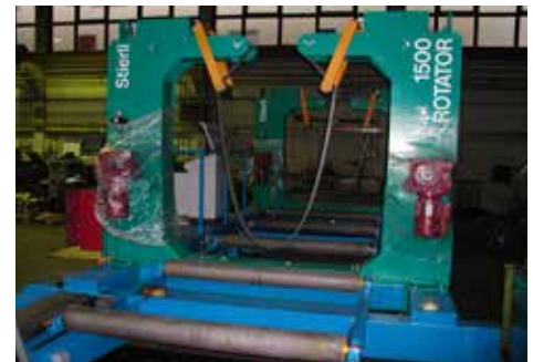
315 Une installation de soudure de poutrelles relles. Rotator in lasinrichting geïntegreerd
