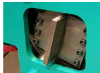
118 Unité de redressage en torsion Torsie richtunit
