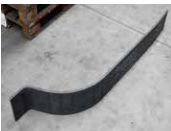
82 Pliage de pièces longues Lange delen buigen
