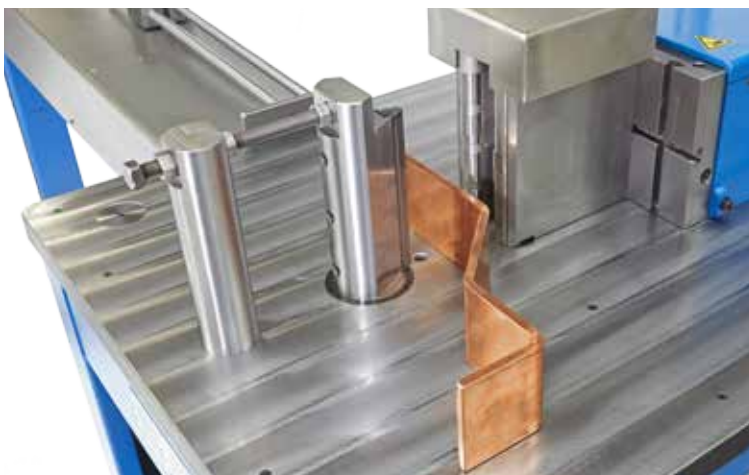
210 Prisme avec système de mesure intégré pour surpliage automatique. Prisma met geïntegreerd meetsysteem voor automatisch nabuigen
