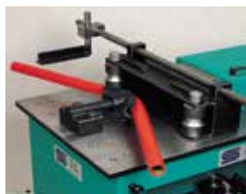
322 Cintrage des tubes Buizen buigen
