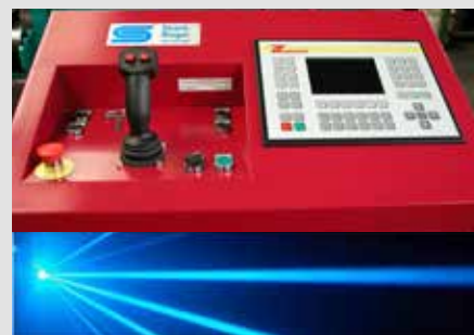
263 Commande CNC avec technologie de pliage au laser CNC- besturing met laser buigtechnologie
