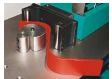
85 Pliage de grands rayons Buigen van grote radii
