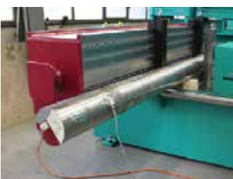
106 Redressage de matériel rond Richten van rond materiaal
