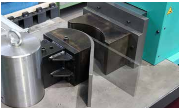
171 Pliage de forme Persbuigen-en vormbuigen
