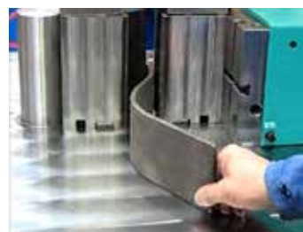
84 Double pliage sans retournement 2 zijdig buigen zonder draaien
