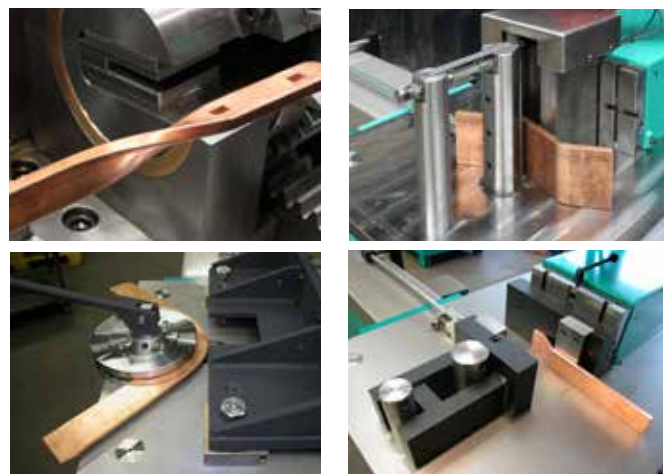
211 Solution d'outils très forte : cintrage en hauteur, torsion, dépose. Smalle buigstempel
