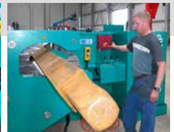
294 Dispositif de retournement Omdraaiinrichting
