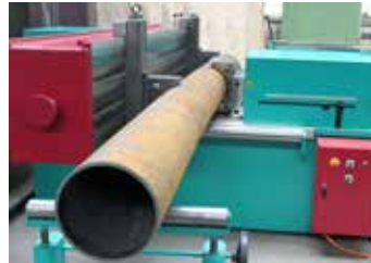
113 Redressage et pliage de tubes jusqu'à 400 mm de diamètre. Buizen buigen tot dia. 400 mm
