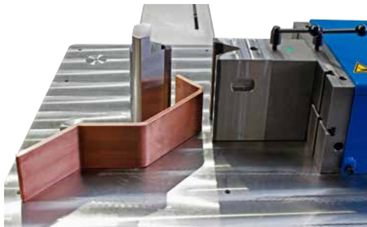
202 Pliage avec prisme standard et programmation rapide d'angle avec CNC-W. Buigen met standaard prisma en snelle hoekprogrammering
