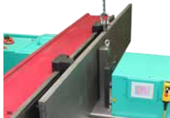
112 Dressage après oxycoupage Richten na thermisch snijden
