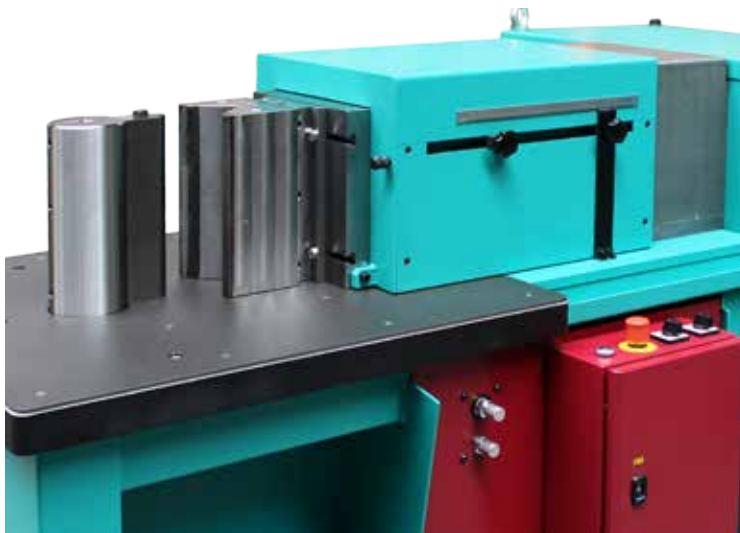
181 Réglage rapide de la course avec un réglage fin de course à partir du modèle de machine 220 HE Slaginstelling d.m.v. mechanische aanslag (vanaf model 220 HE)
