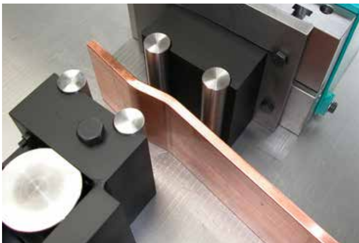
201 Outils avec décalage Afzetgereedschap
