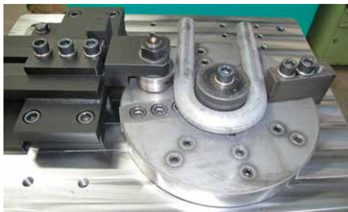
243 Construction de la table standard avec contre pièce de maintien, entraîneur et axe de pliage. / Standaard uitvoering tafel met werkstuk, aandrijving en as voor het buigen.
