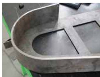
67 Pliage en mode pas-à-pas Buigen met "step-by-step"
