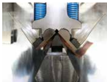
65 Pliage sans marque sur la pièce Buigen zonder beschadiging
