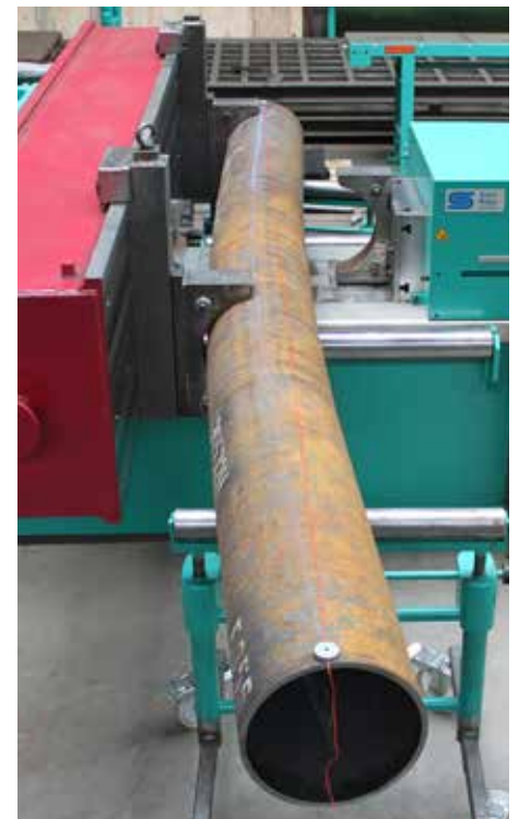
278 Cintrage de tubes jusqu'à diamètre 400mm Buizen buigen tot dia. 400 mm
