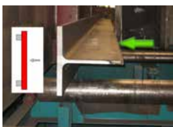
104 Redressage après oxycoupage Richten na thermisch snijden
