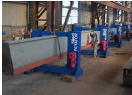
314 Plusieurs Rotator pour pièces très longues Meer rotators voor zeer lange delen
