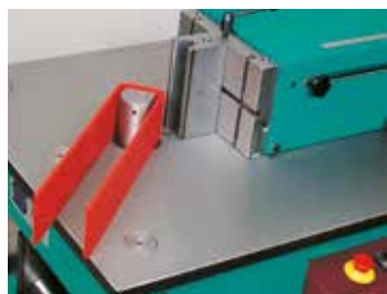
66 Pliage étroit et long côté d'angle Kleine hoeken zetten
