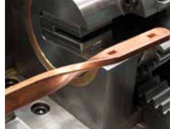
72 Outillage de torsion à 90° Torsiegereedschap 90°
