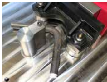
75 Prisme à rouleau Rollen V blokstempel
