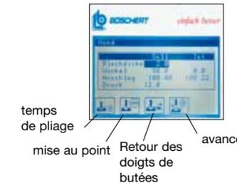
Par une fonction TEACH-IN, il est possible de stocker en mémoire définitivement la spécificité de la matière. Ce système permet d'échapper aux essais de pliage habituels. Selon besoin un appui sur l'une des touches ci-dessus permet d'utiliser d'autres fonctions importantes.
