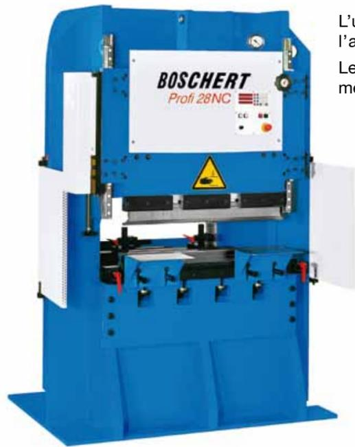
L'utilisation simple de la PROFI 28 NC permet de régler l'angle de pliage sous pression à l'aide d'un volant. Les butées de profondeur (axe x) peuvent être programmées (jusqu'à 99 programmes de 30 lignes chacun).
