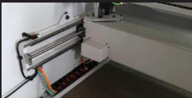
Butée arrière sur double-guidage linéaire avec entraînement par servo-moteurs brushless.
