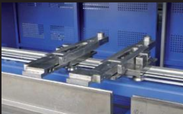
Réglage simple des doigts de butée montés sur roulement à billes. Ce système permet d'utiliser 3 positions de butée jusqu'à une profondeur de 1200 mm.
