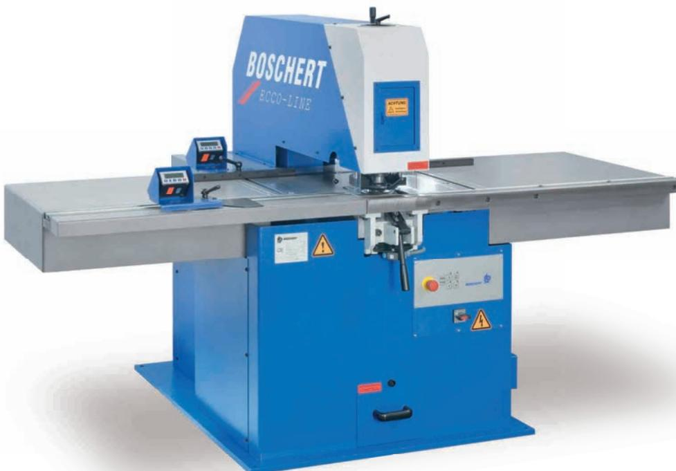
La poinçonneuse hydraulique BOSCHERT ECCO LINE est spécialement adaptée au travail des tôles et profilés. Elle se distingue par sa flexibilité et sa précision.
