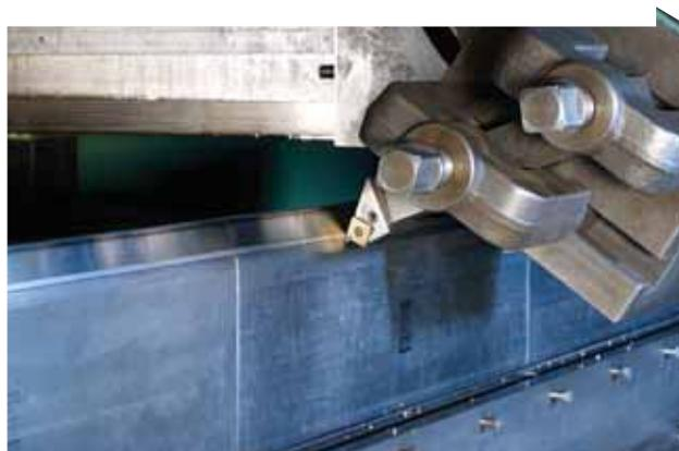
Le rabotage est parfaitement adapté à l'usinage des aciers bruts et des surfaces droites.
