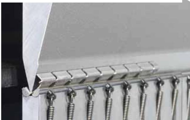
Pliage sans déformation de pièces avec perforations le long de la ligne de trou
