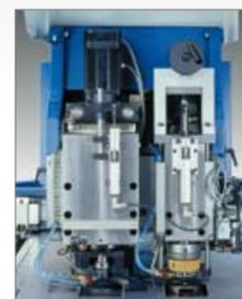
Conception robuste des têtes avec moteur courant continu et système de mesure de course.
