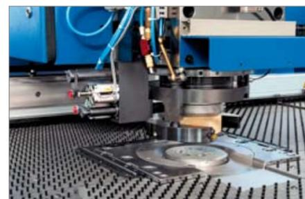
Système d'indexage et réglage automatique de la hauteur
