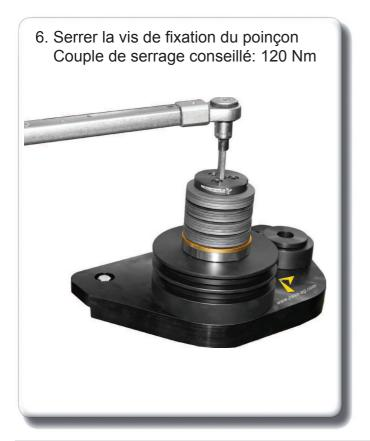
Attention les vis périphériques sur la tête ne doivent en aucun cas être démontées!
