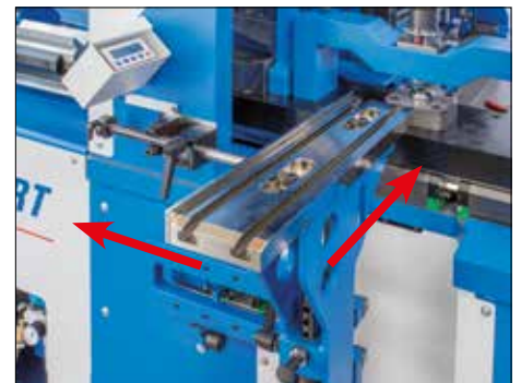
Déplacement de la butée avant avec affichage digital
