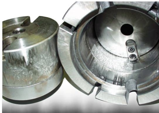
Poinçonnage d'aluminium filmé (après ~ 160 000 coups sans maintenance)
