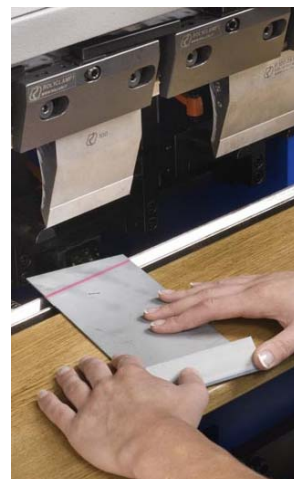
Ligne de pliage éclairée au laser pour un pli parfait
