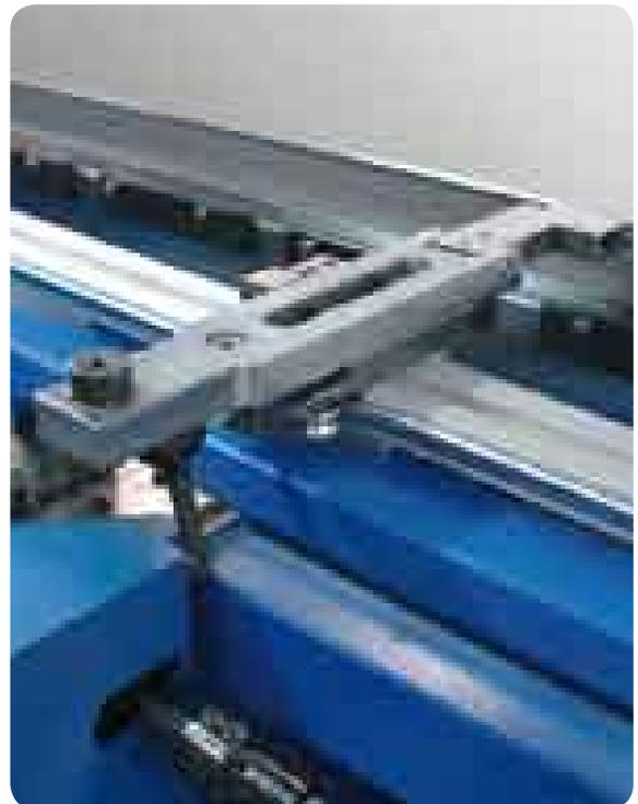
Réglage simple des doigts de butée montés sur roulements à billes. Ce système permet d'utiliser 3 positions de butée jusqu'à une profondeur de 1200mm.
