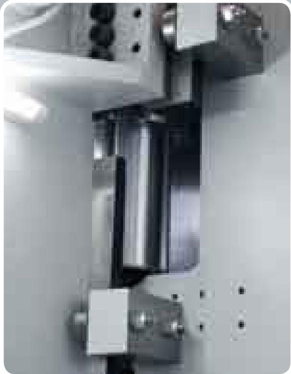
Double-guidage à roulement à billes haut et bas pour un déplacement rapide et précis du tablier.
