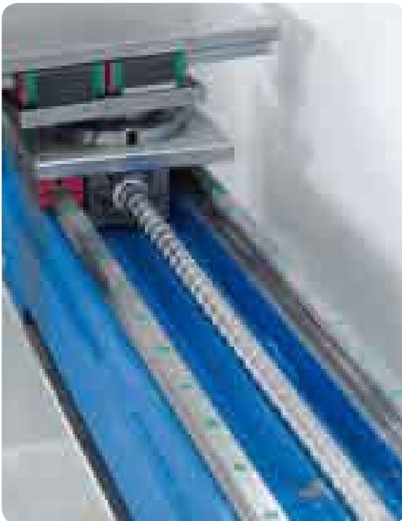
Butée arrière sur double-guidage linéaire avec entraînement par servo-moteurs brushless.
