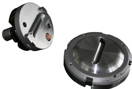
Les outils d'ouverture d'ouïes sont utilisés pour réaliser des fentes de ventilation dans les tôles.
