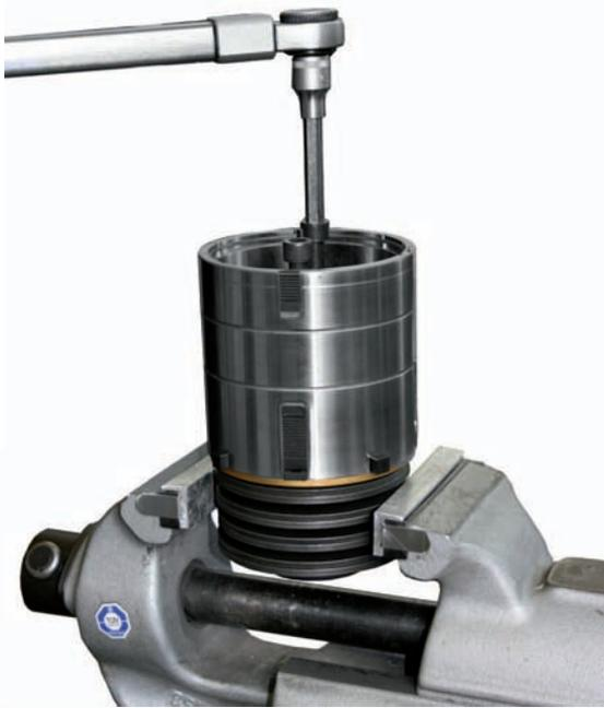
5. Avec l'aide de douille de montage PASS brider le guide dans un étau.
