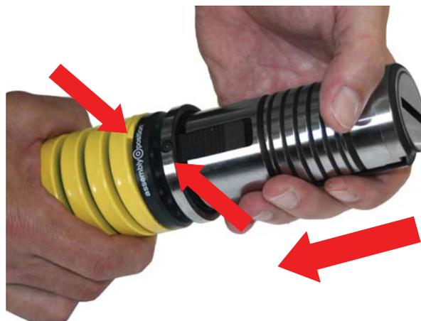
9. Réglage de la longueur du poinçon en actionnant la glissière et en faisant tourner le guide par rapport à la tête.
