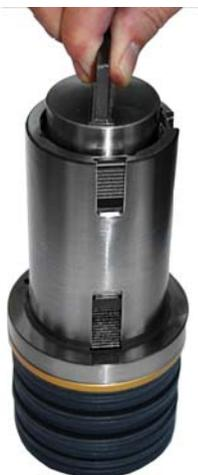
6. Serrer la vis de fixation du poinçon /
