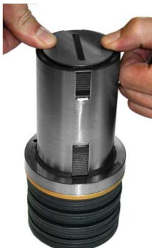
8. Régler la position du poinçon (0,5mm
