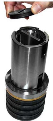
3. Positionner le porte-outil dans la douille PASS adaptée à la station et serrer l'ensemble dans un étau. Ouvrir la vis de fixation du poinçon (clé 6 pans sw=10mm)
