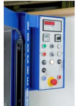
Tableau de commande convivial avec réglage de la pression et compteur de pièces. Sécurité par faisceau lumineux (classe 4) interdisant l'accès lors du fonctionnement.
