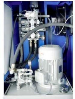
Groupe hydraulique avec système de refroidissement.
