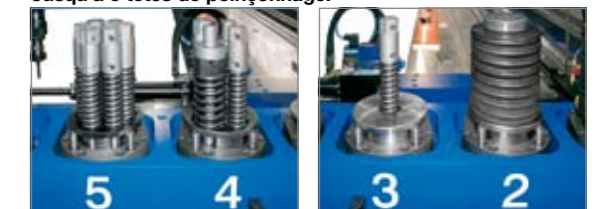
4 ou 6 poinçons par multitool
