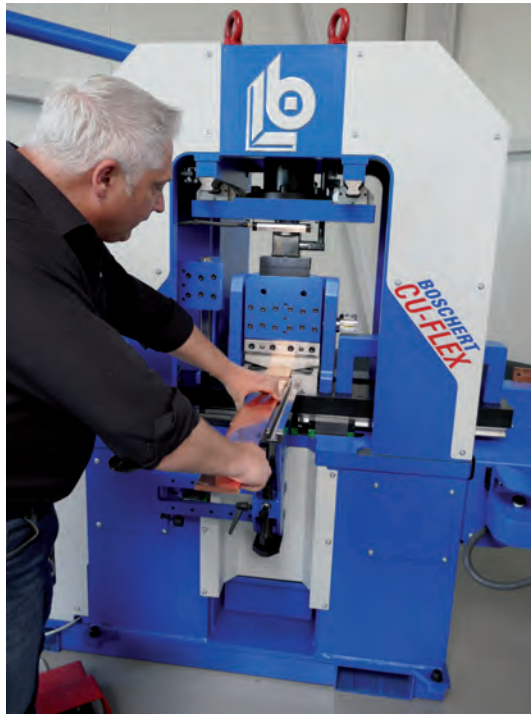
Démonstration du CU-Flex qui combine avec une grande souplesse cisailage, poinçonnage et pliage.
