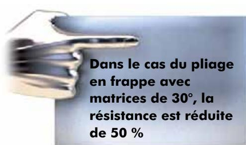
**Dans le cas du pliage en frappe avec matrices de 30°, la résistance est réduite de 50 %**
