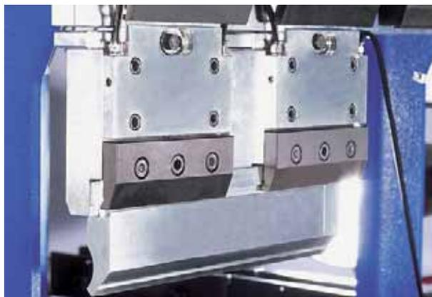
Montage et démontage rapide et simple des outils **avec** blocage pneumatique
