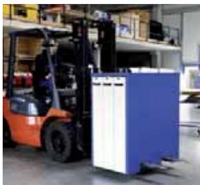
Passages de fourches de chariots élévateurs pour transporter rapidement l'armoire vide à l'emplacement désiré
