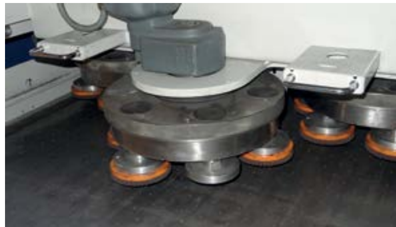
La machine Weber combine l'action des bandes abrasives et de 18 brosses réparties sur 3 têtes planétaires pour assurer l'uniformité du travail sur la zone à traiter.
